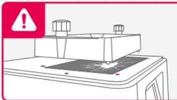
安裝樹脂槽時，請將樹脂槽底部螺絲對準平台凹槽放置，避免螺絲碰撞LCD面板造成損毀。
